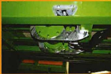
Ein gelenkiger Ansaugarm 10" auf dem vollständig ausgestatteten grünen Gülfass Euroliner
