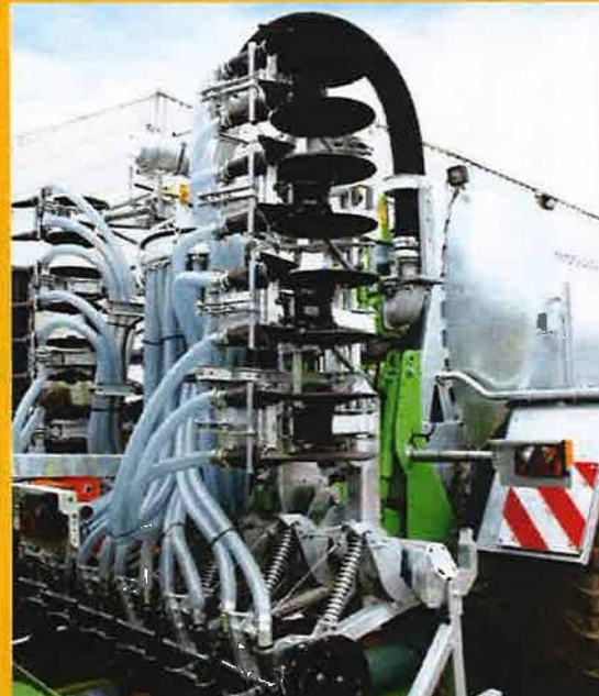
Ein fertiggestelltes Güllefass Modulo2 mit einem Scheibeninjektor Solodisc
